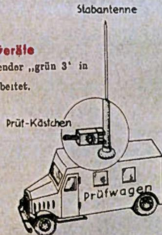
**Merke!** Ist falscher oder kein Ausschlag, so nimm ein Ersatzprüfkästchen und wiederhole die Prüfung. Ist wieder kein Ergebnis zu erhalten, so liegt der Fehler am Verdoppler-Prüfsender.
